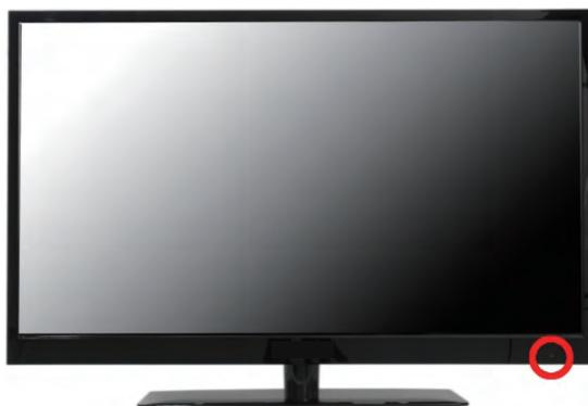
**LAMPE TÉMOIN** - La lumière est rouge lorsque l'appareil est branché, mais le téléviseur n'est pas allumé. La lumière s'allume en bleu lorsque le téléviseur est allumé. **En raison de l'écran LED dans le panneau, le téléviseur peut prendre de 10 à 12 secondes pour s'allumer.**
